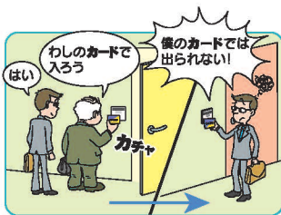
アンチパスバック
